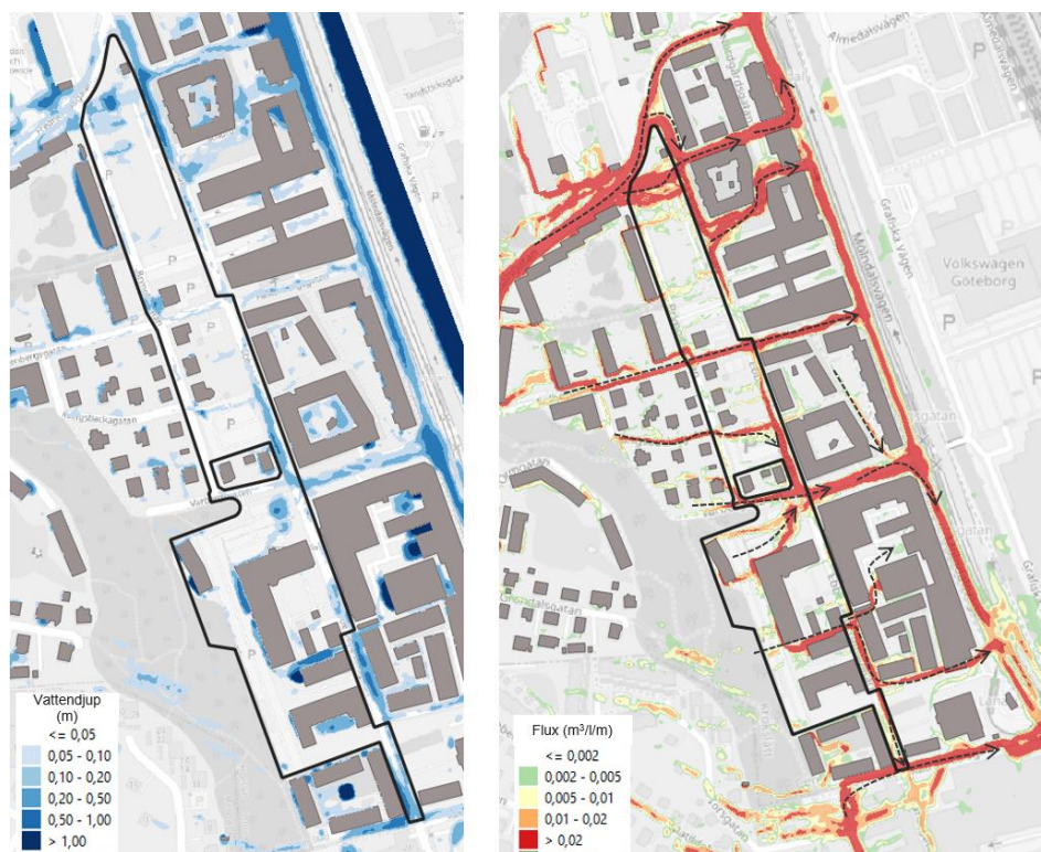
Figur 17 Vänster bild: Befintlig skyfallssituation vid ett klimatanpassat 100års regn. Blå områden visar översvämningsdjup. Höger bild: befintliga flöden vid ett klimatanpassat 100års regn. Pilarna anger ungefärlig flödesriktning.
